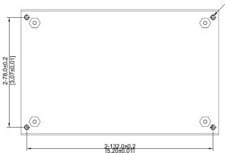
EXTRUDED HOLE M3x0.5(4X) MAX PENETRATION BY SCREW 3.5mm FROM OUTSIDE FACE OF ENCLOSURE
