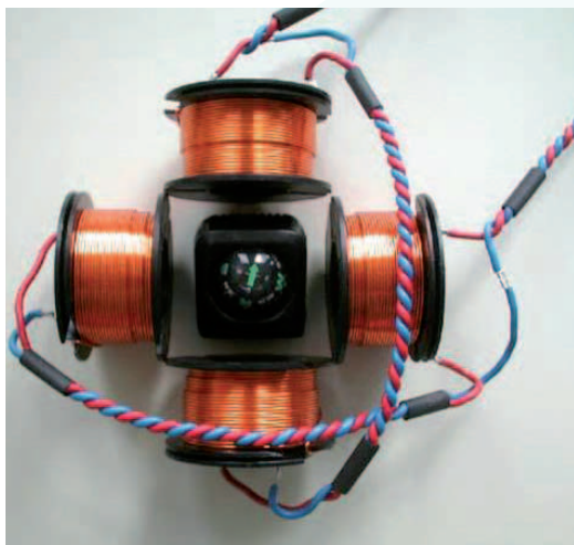
Bild 2: Einfachster Schrittmotor: 4 Spulen, 1 Magnet
