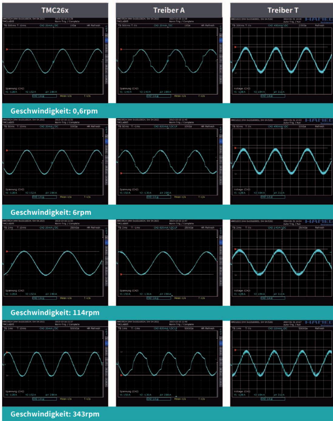
Bild 15: Messwert-Matrix TMC26x, Treiber A & Treiber T
